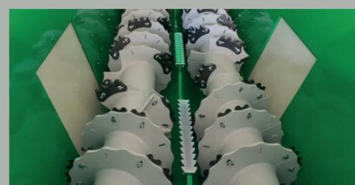
Das Zweischnecken Mischsystem mit gegenläufigen Schneid- und Mischschnecken sorgt für einen perfekten Schnitt sämtlicher Futterarten.
