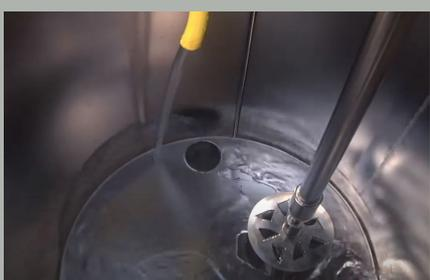
spezielle Propellerblätter sorgen für eine optimale Mischung
