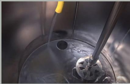
spezielle Propellerblätter sorgen für eine optimale Mischung
